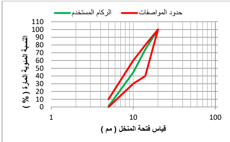
الشكل 2. يوضح منحنى التدرج الحبيبي للركام الخشن
