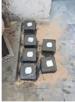
الشكل 3. يوضح صب العينات وتسوية سطحها
